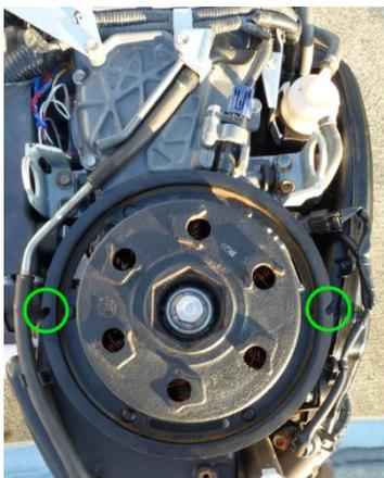
8. Girare il rotore dell'alternatore in senso orario in modo che gli intagli vengano a trovarsi a destra e a sinistra rispetto al rotore dell'alternatore CA, come indicato nella figura.
