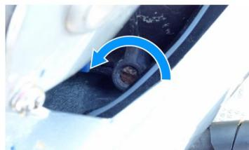
5. Svitare la vite di scarico del separatore del vapore. Scaricare la benzina che fuoriesce dal condotto di scarico nella vaschetta di raccolta.
