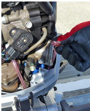
3. Staccare il condotto di scarico dalla sporgenza del collettore di aspirazione ed estrarre l'estremità del condotto di scarico da sotto il coperchio.
