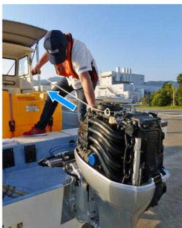
16. Tirare varie volte la fune per l'avviamento d'emergenza per lubrificare l'interno del cilindro. Quindi rimuovere la fune per l'avviamento d'emergenza. Vedere la sezione "Se il sistema di avviamento non funziona" per regolare la fune per l'avviamento d'emergenza.
