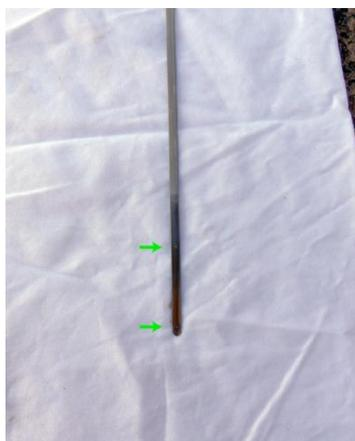
13. Per controllare il livello dell'olio, inserire completamente l'astina all'interno del motore quindi leggere il livello. Il livello dell'olio deve trovarsi tra il limite superiore (A) e il limite inferiore (B).
