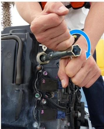
17. Installare manualmente e con attenzione le candele per evitare di incrociare le filettature. Dopo avere montato la candela serrare di 1/8—1/4 di giro. Montare il coperchio dell'ACG.
