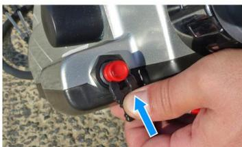
11. Inserire il fermaglio d'emergenza nell'interruttore di arresto d'emergenza. Attaccare bene l'altra estremità del cordone dell'interruttore di arresto d'emergenza all'operatore.
